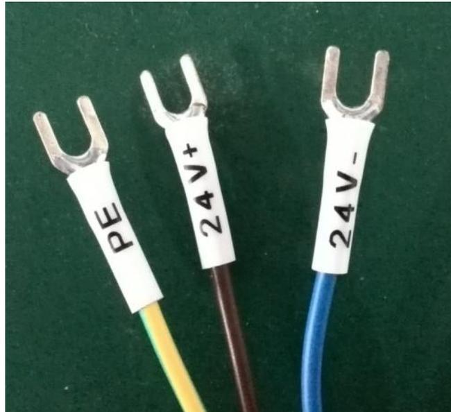
图 3 电源线接头定义
