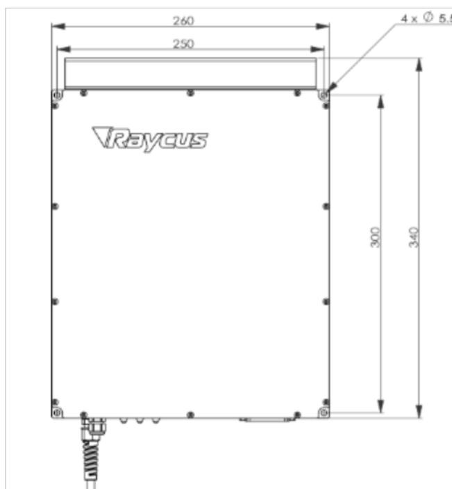
图 2 激光器外形及安装尺寸
