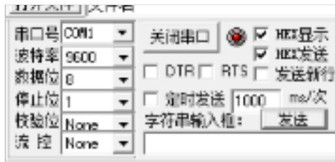
图 11 串口连接设置
