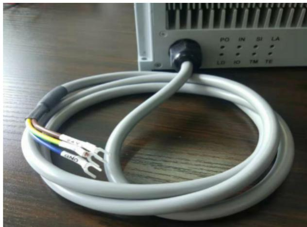
图 4 激光器电源线
