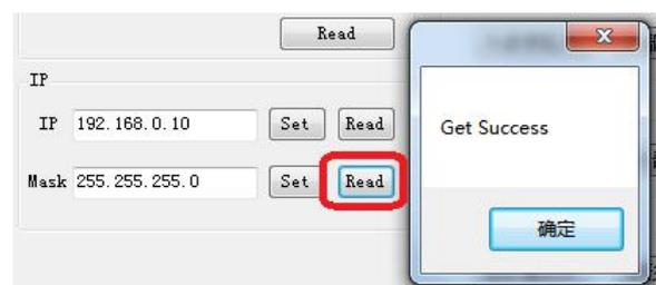
图 15 主界面——激光器子网掩码读取
