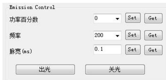
图 24 主界面——工作参数设定、读取和出光控制
