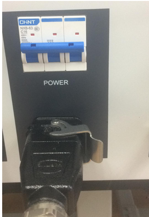
图 8 用锁扣锁上插头
